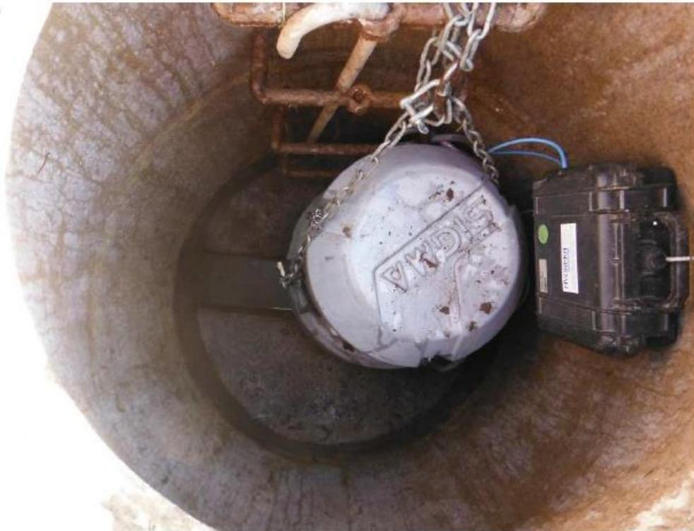
Figure 32 : Préleveur installé sur le réseau du hameau d'Enfer
