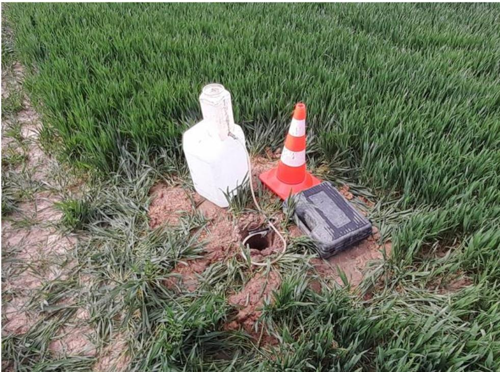
Figure 109 : Réalisation de l'essai de perméabilité
