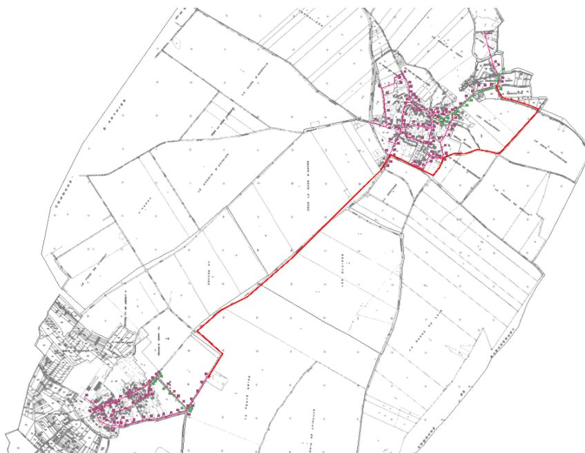
Figure 134 : Tracé pour le refoulement des eaux du bourg vers le hameau
