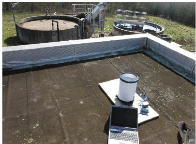
Figure 31 : Pluviomètre installé à la station d'épuration du bourg
